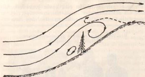
Piirros, joka osoittaa rinteellä kasvavan puurivin aiheuttaman tuulensuunnan taipumisen ylöspäin. Pilkkuviiva osoittaa tätä hyväkseen käyttäneen liitokoneen lentorataa.
