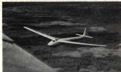
PIK-13:n lujuskerrain on 8. Sallitut nopeudet: vintturilähtö 115 km/t, lekohinaus 130 km/t ja syöksy 250 km/t. Valok. Mellén.
