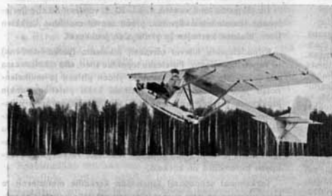
Harokka III (PIK-7) on anastuneen sarjansa viimeisin muunnos, jossa erikoisuutena on pyörä ja palkkirunko. Valok. Mellén.
