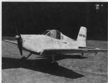
Keltiäinen ennätyslentokunnossa: toinen lisäpolttoainesäiliö näkyv kuvassa rungon alla, toinen oli sijoitettuna kuoman matkatavaralokeroon. Laskutelineen joustintuet oli profiiloitu balsamuodostuksilla.
